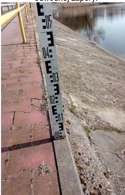
Fot.16. Lokalizacja punktów pomiarowych niwelacji podłużnej zapory ziemnej czołowej – góra krawężnika chodnika od strony WG.
