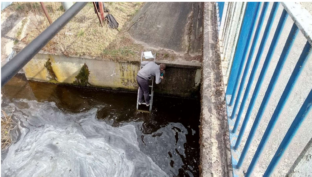
Fot.29. Badanie betonów jazu piętrzącego – metoda sklerometryczna.
